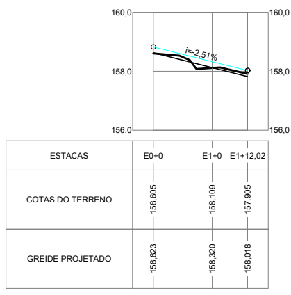
TRECHO FA RUA MARIA S. FUGUEIREDO - E0+0 ATÉ E1+12,02 PERFIL LONGITUDINAL - ESC.: V=1:100 H=1:1000
