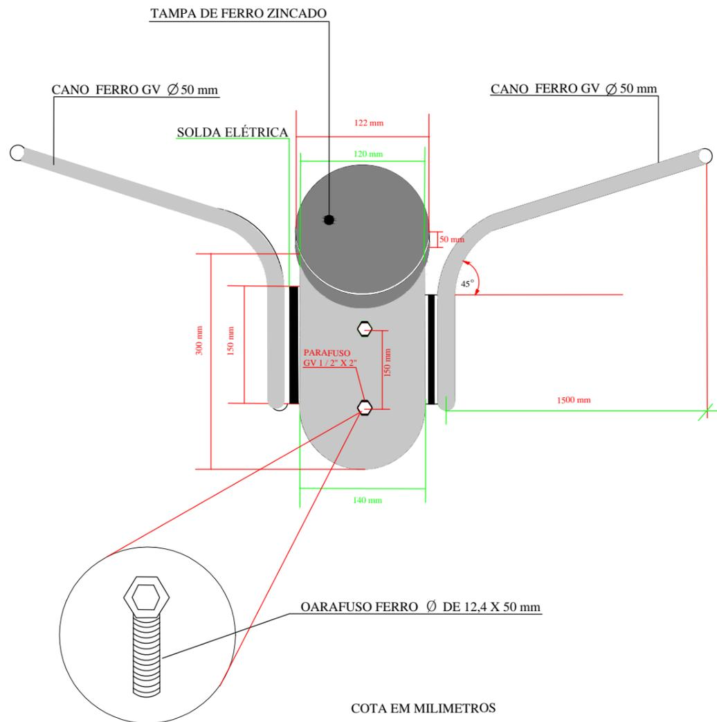
DETALHES CONSTRUTIVOS DO SUPORTE COM 02 BRAÇOS PARA INSTALAÇÃO DE LUMINÁRIA EM POSTE DE CONCRETO CIRCULAR.
