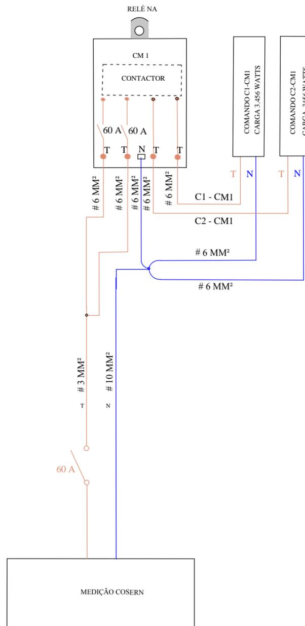
DIAGRA UNIFILAR DA LIGAÇÃO DAS CHAVES MAG. 01 DA MEDIÇÃO 03.
