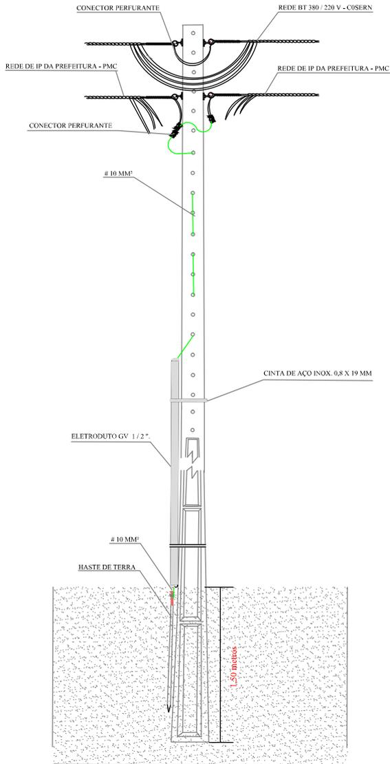
**DETALHE INSTALAÇÃO DO ATERRAMENTO**
